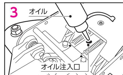
3 ほぼ完全にオイルを排出した後にジャッキ専用作動油【別売】“P10 関連商品 参照”をオイル注入口から注入してください。またオイル注入中にゴミなどが入らないように注意してください。
