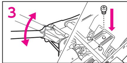
3 ハンドルをすばやく10回程度ポンピングしてください。この動作をすることにより、パワーユニット内部に入っていたエアが抜けて正常に動作します。作業終了後、オイルプラグを取り付け、元の状態に戻してください。
