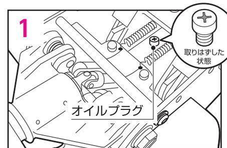
1 カバーを取りはずし、リリースバルブをゆるめリフティングアームを最下位まで下げてから、プラスドライバーでオイルプラグを反時計方向に回して取りはずしてください。
