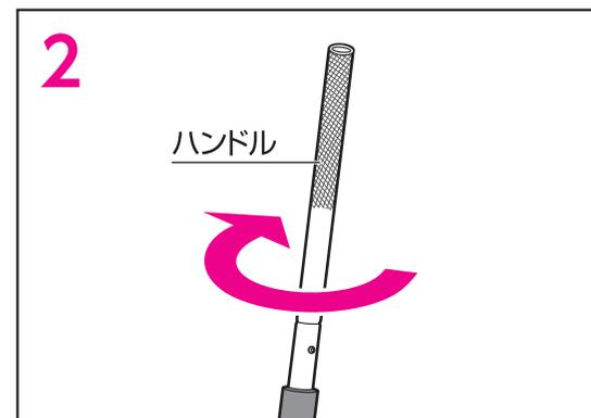
2 ハンドルの角穴とハンドルソケット内部の角軸の向きを合わせてハンドルを差し込んでください。ハンドルを引っ張り、ハンドルが抜けないことを確認してください。ハンドルが抜ける場合は、ハンドルの角穴とハンドルソケット内の角軸の向きを確認してください。ハンドルを両手で持ち、時計回りに確実に締め付けてください。
