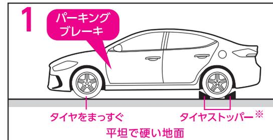
1 平坦で硬い地面に車両を停車し、パーキングブレーキを確実にかけ、左図を参照にタイヤストッパー(輪止め)【別売】“P10 関連商品 参照”をセットしてください。
