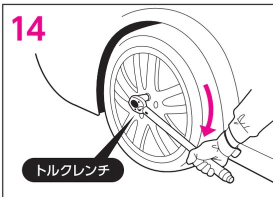
14 ジャッキを安全なところまで移動させて、トルクレンチ【別売】“P10 関連商品 参照”を使用し、規定のトルク値でホイールナットを本締めしてください。
