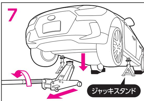
7 ジャッキスタンドを、車両のジャッキポイントの真下になるように合わせて置き、リリースバルブを反時計回りにゆっくり回し、ジャッキスタンドが車両を維持するまでジャッキダウンします。
