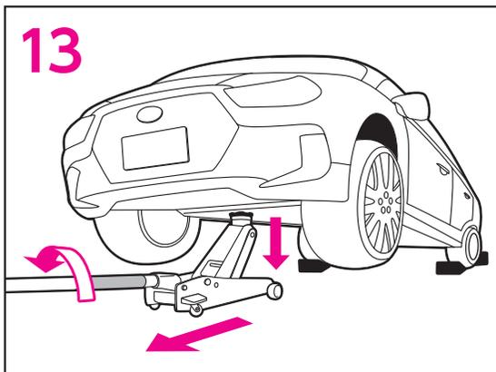
13 車両の下に入れているジャッキスタンドをはずし、リリースバルブを反時計回りにゆっくり回しジャッキダウンしてください。
