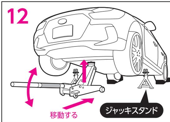
12 作業後、再びジャッキをジャッキポイントまで移動させ、リリースバルブを時計回りに回してリリースバルブを確実に締め付け、ジャッキスタンドが取りはずせる高さまでジャッキアップします。
