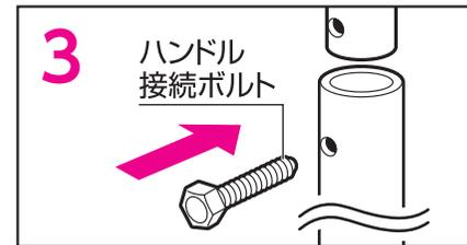
3 2本のハンドルを接続して、ハンドル接続ボルトを確実に締め付けてください。
