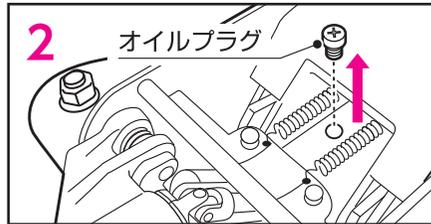
2 カバーを取りはずし、六角棒レンチでオイルプラグを反時計方向に回して取りはずしてください。
