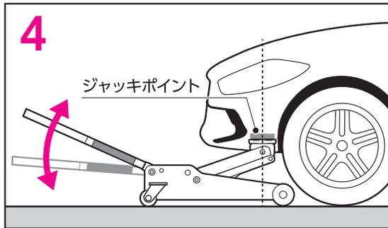
4 ハンドルを上下に動かしジャッキポイント付近まで上昇させ一度停止し、荷重の中心がサドルの中央にかかることを確認してください。
