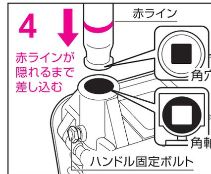
4 ハンドル固定ボルトをゆるめてハンドルをハンドルソケットに赤ラインが隠れるまで差し込み、ハンドル固定ボルトを確実に締め付けて、ハンドルが抜けないことを確認してください。
