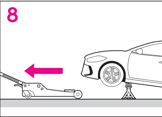
8 ジャッキスタンドが、車両を完全に支えていることを確認し、ジャッキのサドルを下げる安全なところまで、車両から離してください。
