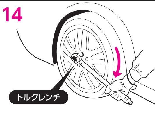
14 ジャッキを安全なところまで移動させて、トルクレンチ【別売】“P10 関連商品 参照”を使用し、規定のトルク値でホイールナットを本締めしてください。
