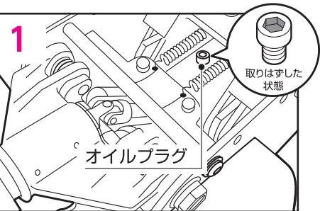
1 カバーを取りはずし、リリースバルブをゆるめリフティングアームを最下位まで下げるから、六角棒レンチでオイルプラグを反時計方向に回して取りはずしてください。
