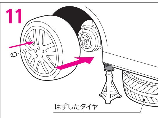
11 交換用タイヤを取り付け、ホイールナットを手で回して取り付け後、ホイールナットレンチまたはクロスレンチなどを用いて仮締めし、車両の下に敷いたタイヤを取り出してください。
