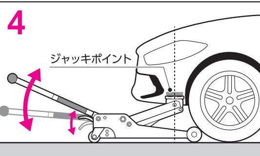
4 フットペダルまたはT型ハンドルを上下に動かし、ジャッキポイント付近まで上昇させ一度停止し、荷重の中心がサドルの中央にかかることを確認してください。
