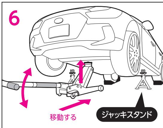
6 ハンドルを上下に動かして、ジャッキスタンド、ジャッキアップ用アダプター【別売】“P10 関連商品 参照”がセットできる高さまでジャッキアップしてください。ジャッキアップに伴いジャッキの車輪が回転し、ジャッキが矢印の方向に移動していることを確認してください。ジャッキが移動しない場合は作業を中止してください。ジャッキポイントからサドルがはずれ、車両が落し下り使用者が死亡したり重傷を負う危険性があります。
