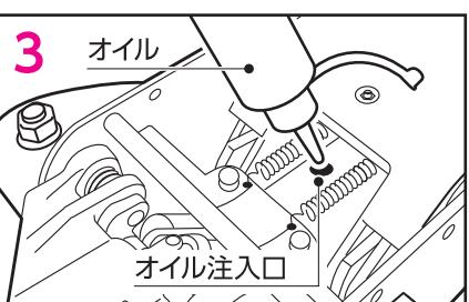
3 ほぼ完全にオイルを排出した後にジャッキ専用作動油【別売】“P10 関連商品 参照”をオイル注入口から注入してください。
