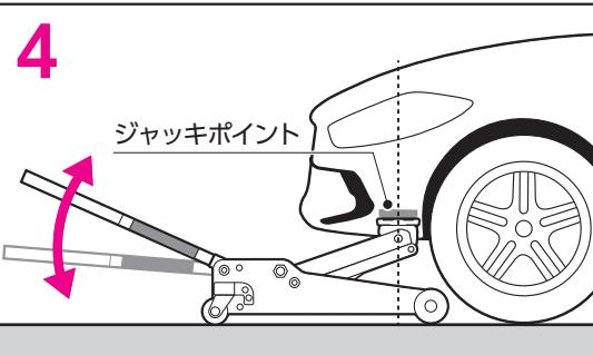
4 ハンドルを上下に動かしジャッキポイント付近まで上昇させ一度停止し、荷重の中心がサドルの中央にかかることを確認してください。
