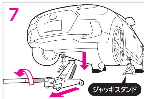
7 ジャッキスタンドを、車両のジャッキポイントの真下になるように合わせて置き、リリースバルブを反時計回りにゆっくり回し、ジャッキスタンドが車両を維持するまでジャッキダウンします。
