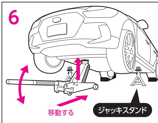
6 ハンドルを上下に動かして、ジャッキスタンド、ジャッキアップ用アダプター【別売】“P10 関連商品 参照”がセットできる高さまでジャッキアップしてください。ジャッキアップに伴いジャッキの車輪が回転し、ジャッキが矢印の方向に移動していることを確認してください。ジャッキが移動しない場合は作業を中止してください。ジャッキポイントからサドルがはずれ、車両が落下し使用者が死亡したり重傷を負う危険性があります。
