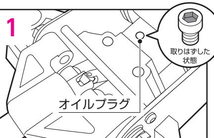
1 リリースバルブをゆるめリフティングアームを最下位まで下げてから、六角棒レンチを使用しオイルプラグを反時計方向に回して取りはずしてください。
