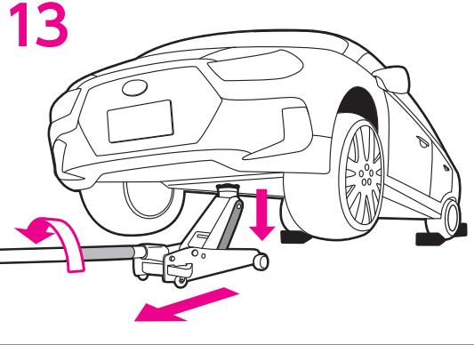
13 車両の下に入っているジャッキスタンドをはずし、リリースバルブを反時計回りにゆっくり回しジャッキダウンしてください。
