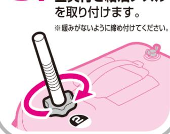
4. ガス抜き調節ネジを一度締めつけてください。
